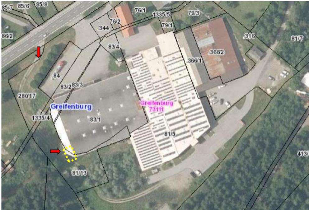
Der gelb markierte Bereich im Bild soll dann abgetragen werden und an dieser Stelle wird ein Rolltor eingebaut.
